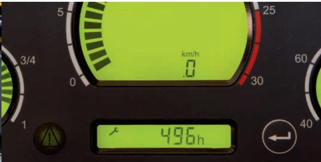
**ИНДИКАТОРЫ ПРОФИЛАКТИЧЕСКОГО ТЕХНИЧЕСКОГО ОБСЛУЖИВАНИЯ, ПОЗВОЛЯЮЩИЕ ИЗБЕЖАТЬ ПОЛОМОК**
